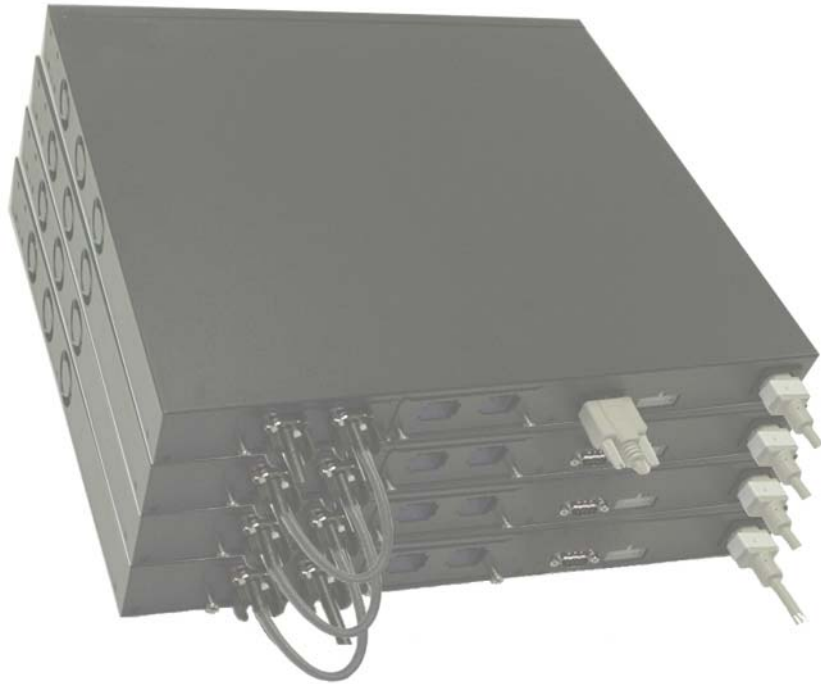
Εικόνα 1-3. Συνδεση μεταγωγων σε συνδεσμολογια στοιβας
