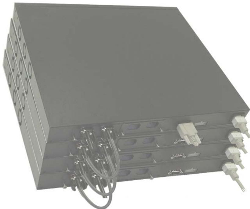
Figure 1-3. Connexion d'une pile de commutateurs
